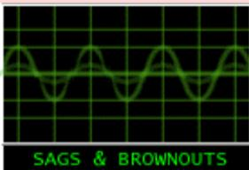
**Subidas y Bajadas** constantes son producidas normalmente por conexiones y paros de motores, ó por cambios encendidos de cargas muy inductivas en la Red.
